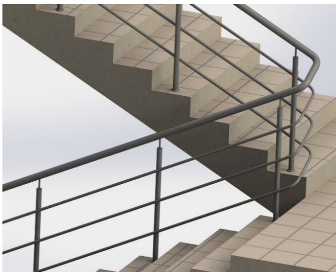
Поручень Ф40мм , стойка Ф38мм, ригель Ф16мм.
