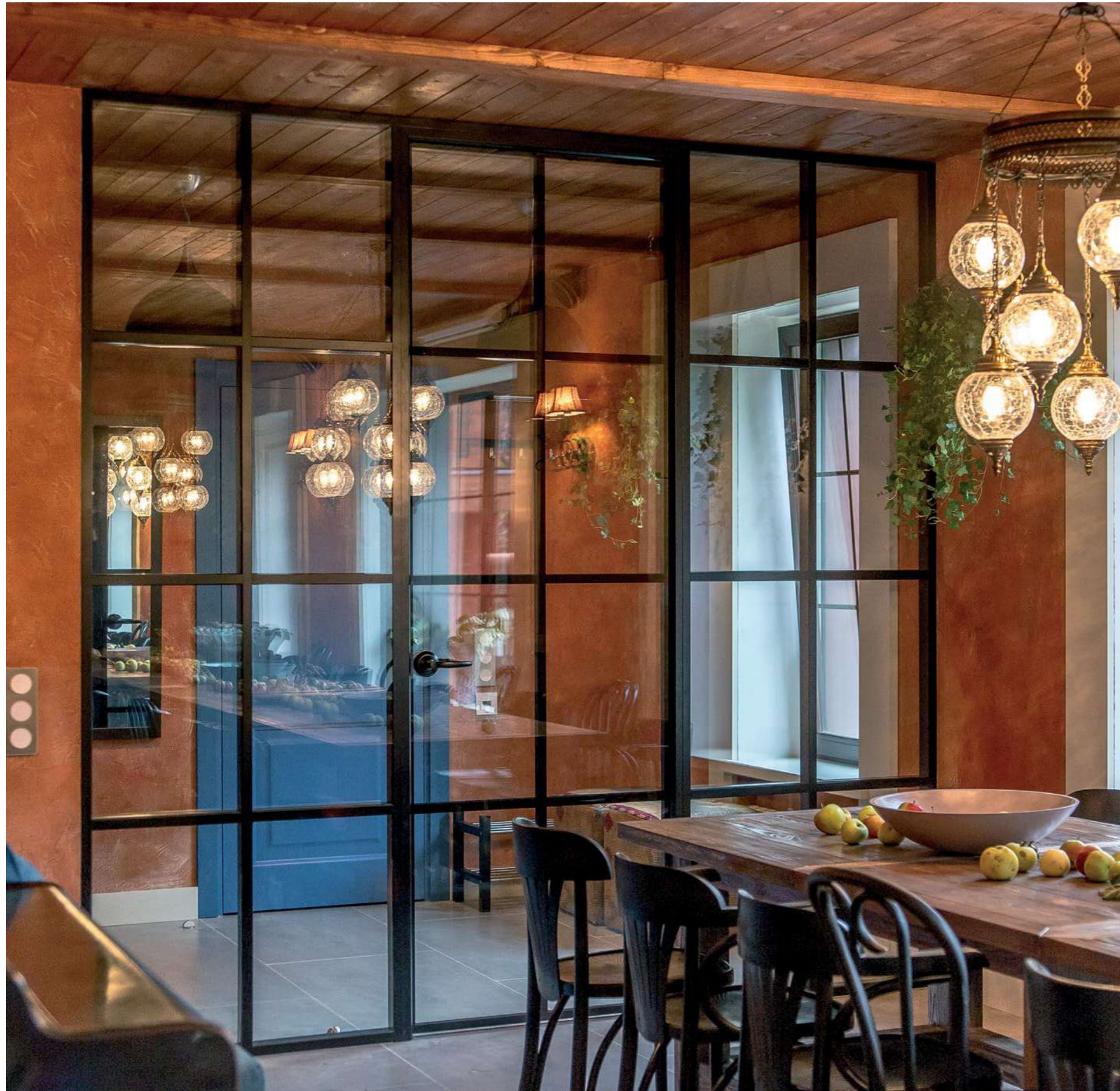
Полотно INTERO N в перегородке NAYADA-Standart Профиль окраска по RAL 9005. Стекло прозрачное закаленное с окраской RAL 9005 по трафарету. Ручка Hoppe HCS окрашена в RAL 9005.
